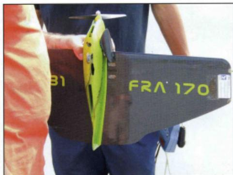
Un modèle de Team Racing, avec aile carbone et train rentrant. Dessous, notez sur le bras de ce mécanicien, le système sous pression permettant de faire le ravitaillement du modèle en quelques secondes.
